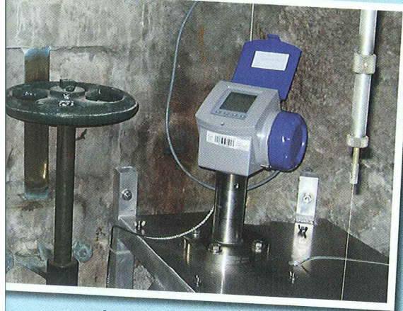
Le marégraphe moderne fonctionne avec des rayons laser.
